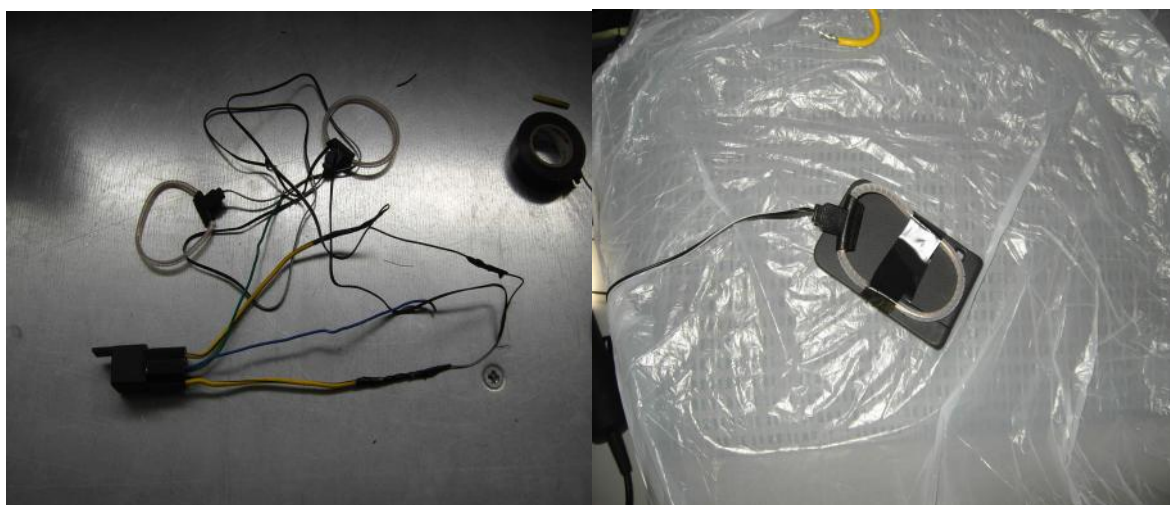
Рис.1. Внешний вид самодельного обходчика иммобилайзера (слева). Расположение антенны обходчика на карточке-ключе (справа).
